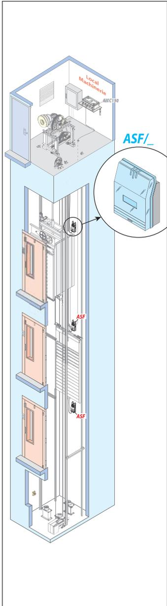
Licht-Warnerichtung (LED) + Bip-Alarm. Komplettes Gerät für 24V Gleichstrom mit Anschlüssen, Ableitungen, Empfänger, mit Anschlüssen & 4,5 m für ASF/ASF-Verkabelung.
